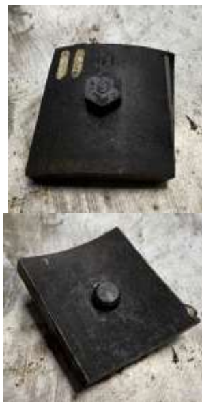
Заглушка из магниевого сплава в водопроводной воде с 7% Талкор-М 7 суток
