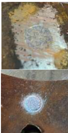
Заглушка из магниевого сплава в водопроводной воде 7 суток
